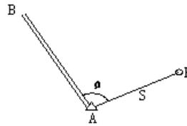
图8-1 极坐标法监测示意图
