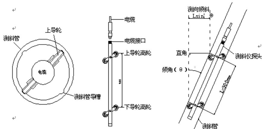
图8-5 测斜仪位移计算原理
